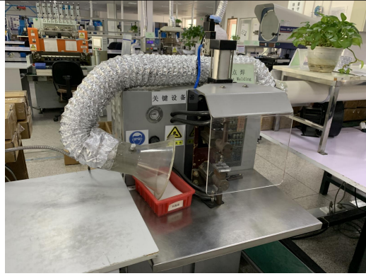
焊接废气集气装置
