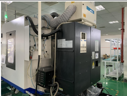
设备自带除尘装置
