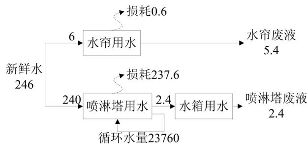
图 2.7-1 本项目水平衡图（单位：t/a）
