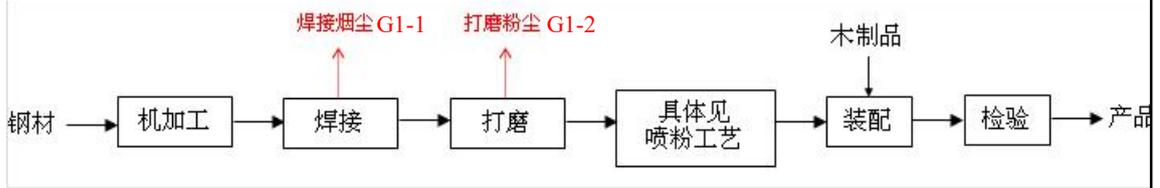
图 2-14 展架产品（材质为钢材）生产工艺流程及产污环节图
