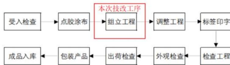
图 2-3 现有车载摄像头生产工艺流程图
