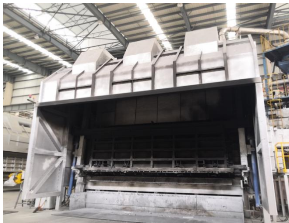
图 4-1 本项目合金调配炉导流烟气罩设置示意图
