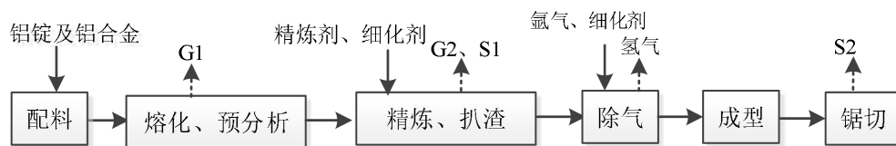
图 2-3 铝镁合金材料研发实验工艺流程图
