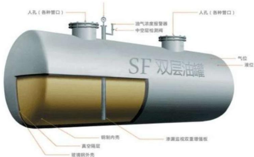
图 2-10 SF 双层油罐构造
