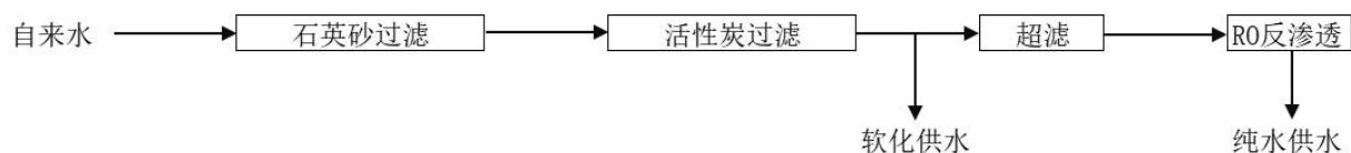
图 3.1.3-1 软水、纯水制备工艺流程图
