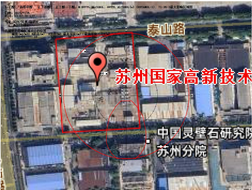
图 6.2-1 正丁醇储罐泄漏事故各阈值的廓线
