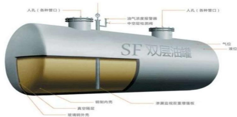
图 2-8 SF 双层油罐构造
