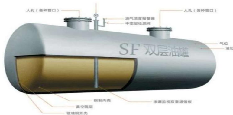
图 2-10 SF 双层油罐构造
