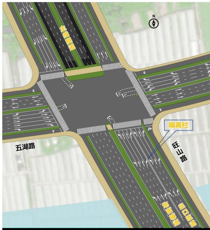
图 2.3-6 东太湖隧道辅路-五湖路交叉口方案平面布置图
