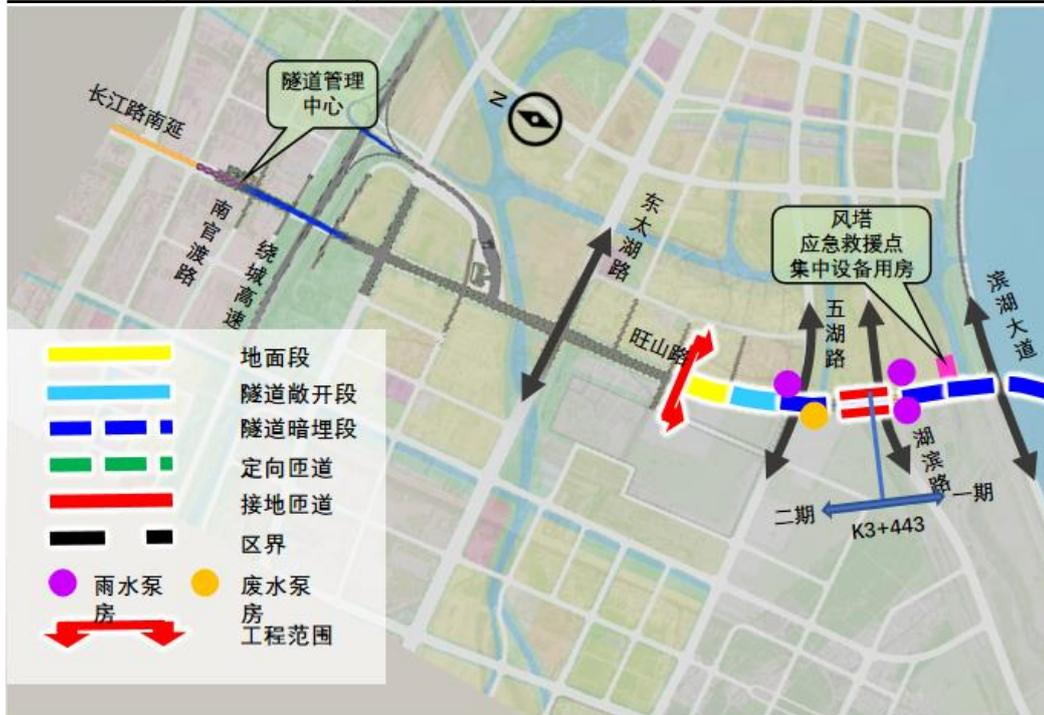
图 2.4-5 东太湖隧道二期工程（吴中段）雨污水泵房平面布置图
