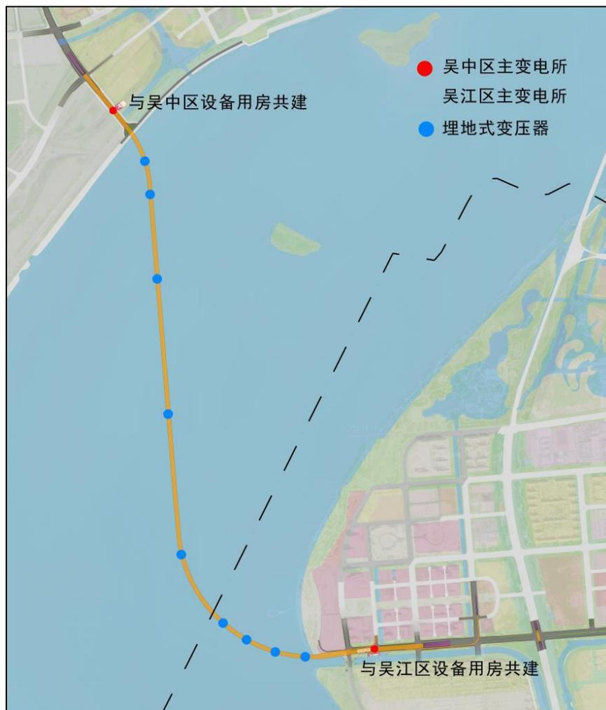
图 3-7 隧道供配电平面布置图
