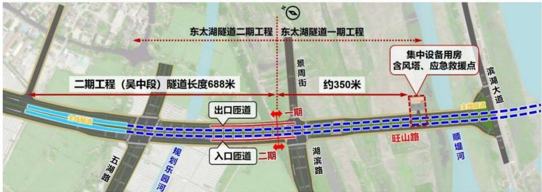
图 2.4-3 东太湖隧道二期工程（吴中段）附属设备用房平面布置图
