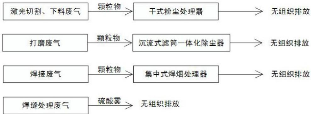
图 2-6 现有项目废气处理及排放示意图
