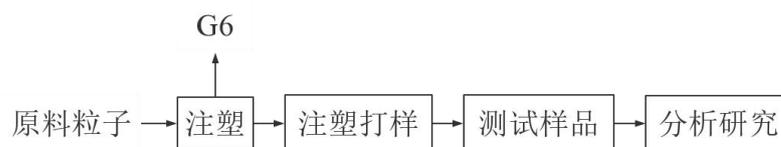
图 2-4 测试工艺流程图
