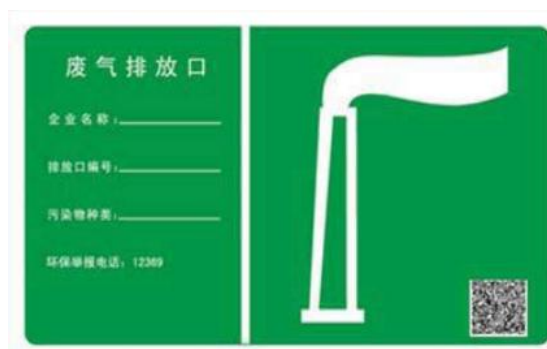
图 9.2-1 废气排放口规范化标识牌
