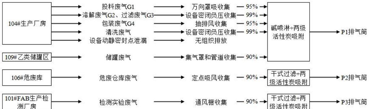
图 6.1.1-1 废气收集及处理示意图
