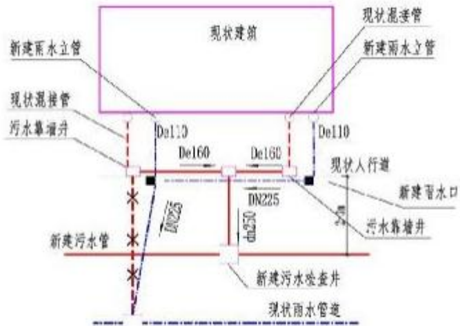
图 2-2 雨水立管改造方案图
