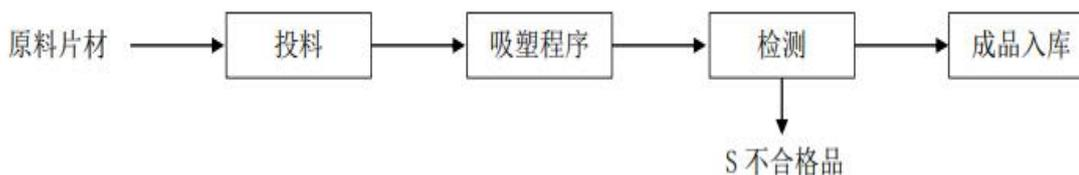
图 2-4 生产工艺流程及产污环节
