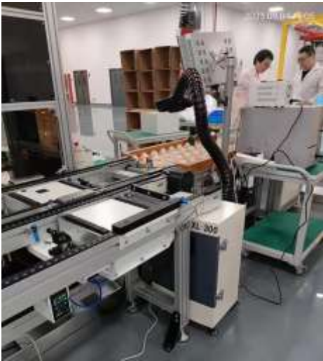
图 3-2 移动式有机废气处理装置
