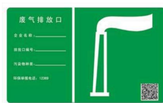
图 9.2-1 废气排放口规范化标识牌
