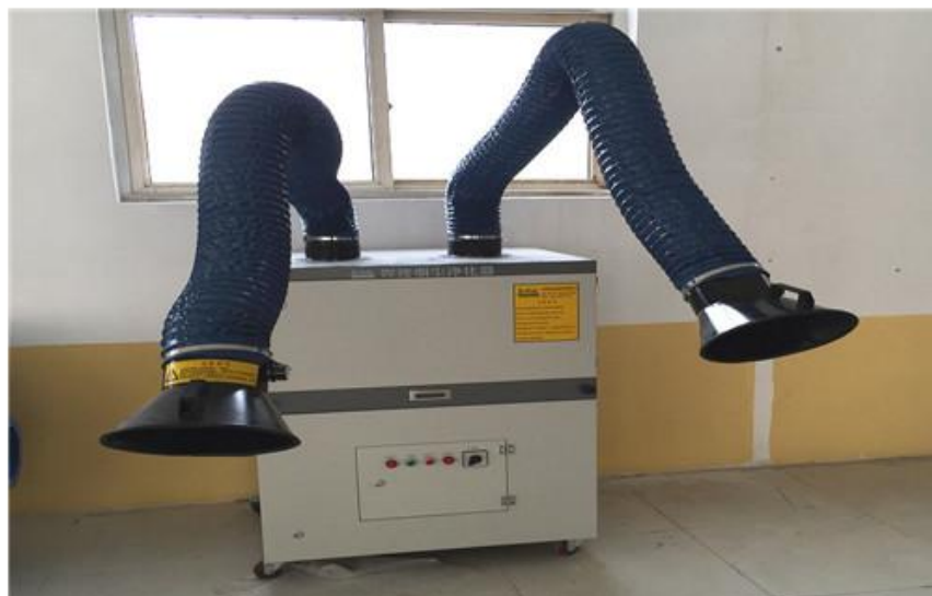
图 4-2 移动式焊接烟尘除尘装置示意图
