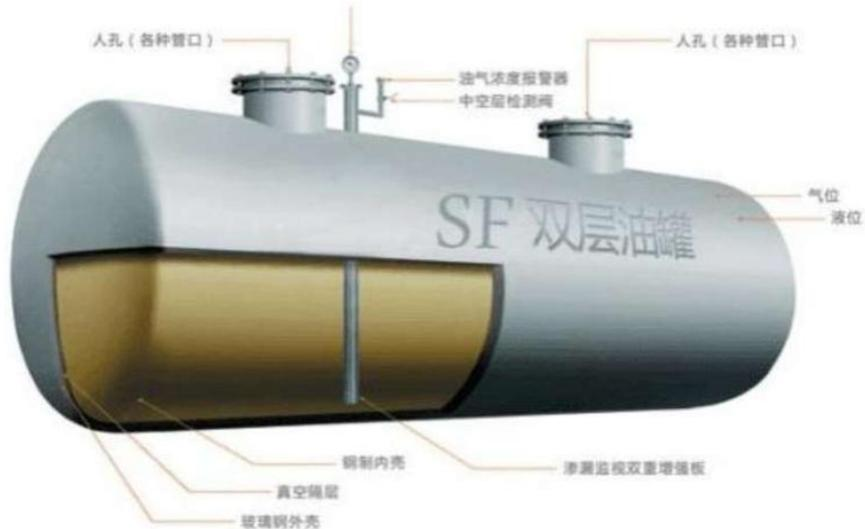
图 2-9 SF 双层油罐构造
