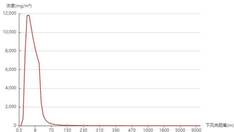
图 6.2-2 甲醇原料桶泄漏最不利气象条件下风向距离浓度曲线图
