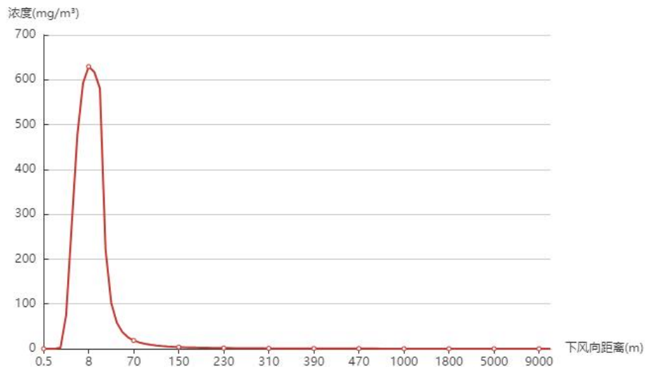
图 6.2-2 乙酸乙酯泄漏火灾事故次生 CO 最不利气象条件下风向距离浓度曲线图
