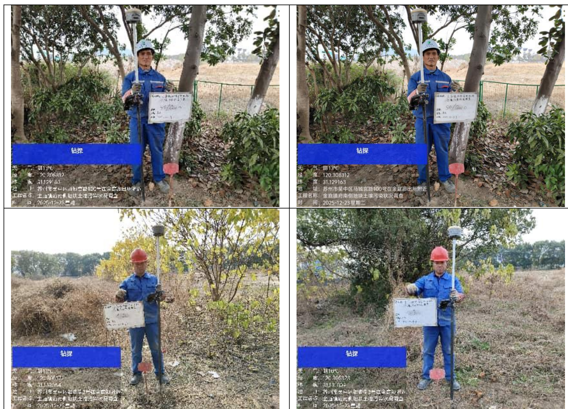
图 5.2.2 RTK 现场定位
