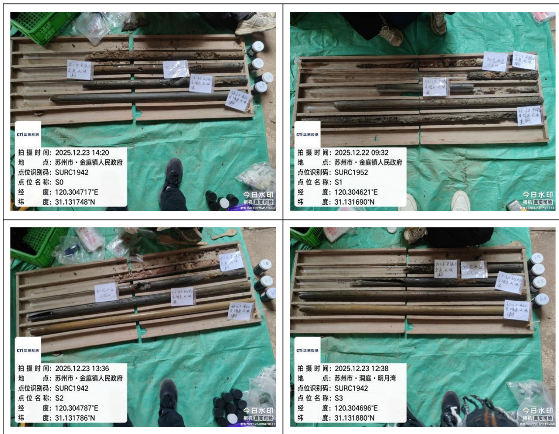
图 5.2.6 采集的土壤样品管
