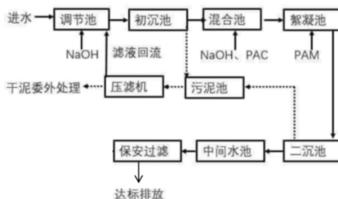
图 4-4 废水处理系统 2 工艺流程图
