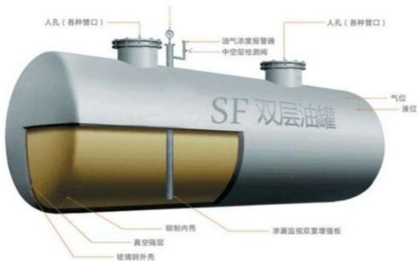
图 2-9 SF 双层油罐构造
