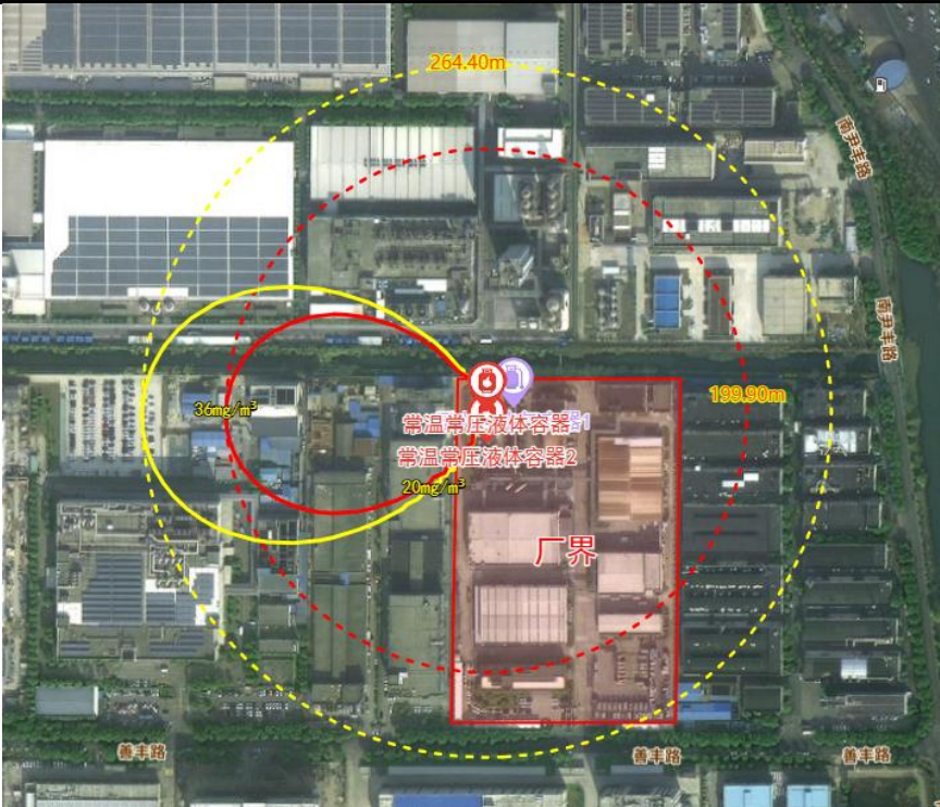
图 6.2-1 氢氟酸储罐泄漏不同毒性终点浓度最大影响范围图
