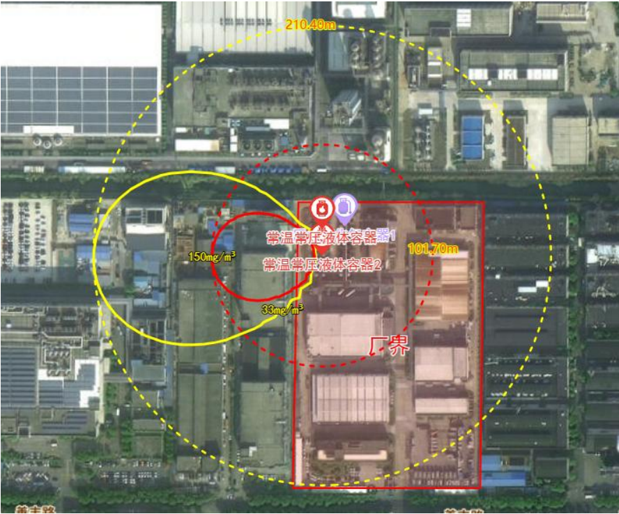
图 6.2-3 盐酸储罐泄漏不同毒性终点浓度最大影响范围图
